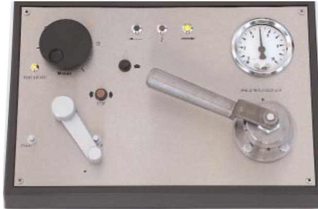
Rangierstellung: Der schwarze Drehregler für die Massensimulation (Personen- oder Güterzug) wird auf die Stellung Rangieren gedreht. Nun wirkt das Bremsventil als Zusatzbremsventil direkt auf die Lokbremse.
