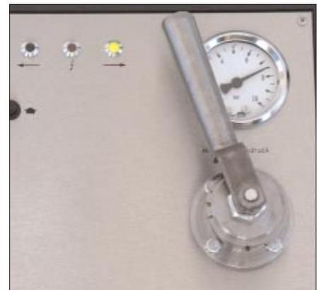
Füllstellung: Bremsleitung wird gefüllt
